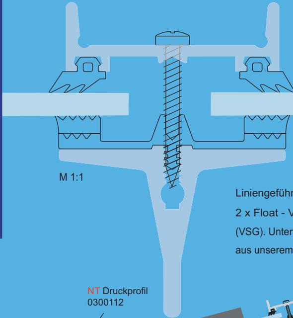
Liniengeführte Dachverglasung aus 2 x Float - Verbundsicherheitsglas (VSG). Unterbau und sonstige Module aus unserem GWS - Programm.
